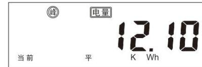
\*注: 显示页面下部的 平 表示平时段电量, 若显示峰、谷、尖则对应峰、谷、尖电量下同。
