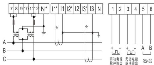
三相三线电压经PT, 电流经CT接入
