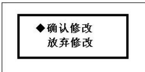
选择窗口提示是否确认定值修改，移动光标，按【确认】键即可选择“取消”或“确认”，如果选择“取消”，则内存中的新定值被放弃，原有定值不发生任何变化。如果选择“确认”，则修改的新定值由装置内存固化到装置主板硬件上，固化完成后，即刻成为当前实际使用定值，原有定值被覆盖，同时弹出如下对话框：
